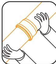
Introducir el extremo macho en la cabeza hembra hasta hacer tope en el fondo de la misma, retirar 1cm, para ello marcar previamente el tubo. El espacio que queda en las uniones permite absorber las dilataciones y contracciones del sistema.
