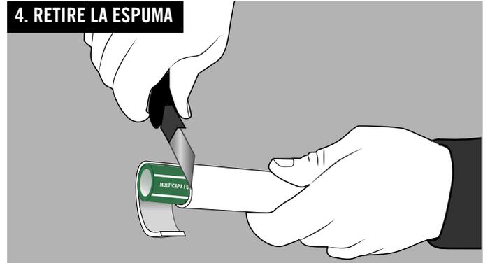
Si se utilizan tubos MAXUM, marcar y cortar con trincheta la espuma termoplástica antes de realizar la fusión.
