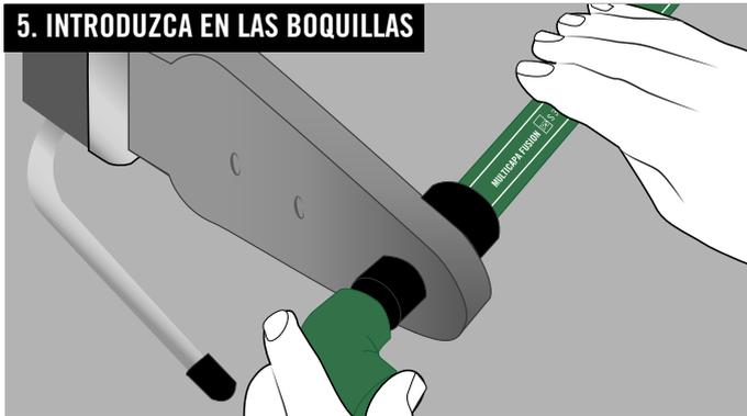
Introducir en forma simultánea tubo y conexión (fusora a 260 °C.) Ejercer presión (sin girar) hasta llegar a tope, sin sobrepasar las marcas. Mantener y dejar transcurrir el tiempo mínimo requerido, según Tabla.
