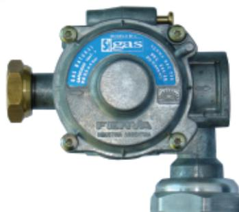
**Regulador de presión SIGAS C6 con dispositivo de seguridad y corte por sobre presión de salida, para instalar en redes de propano gaseoso de 0,5 a 2 bar, aprobados según norma NAG 235, para 4 m<sup>3</sup>/h y presión de salida de 28 mbar.**
